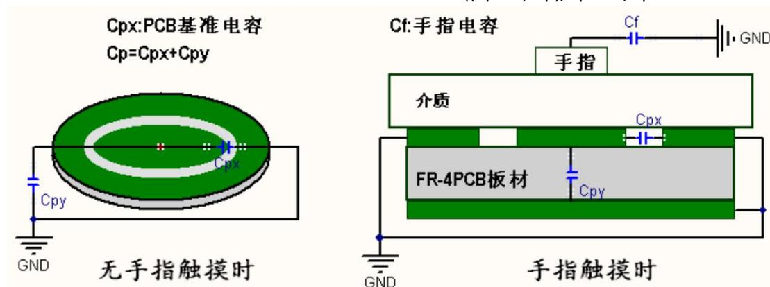
这个电容的变化引起芯片内部振荡频率或充放电时间的变化，使芯片内部能够检测到触摸发生，从而产生触发信号。电容的变化率越大，触摸就越易检测到。
