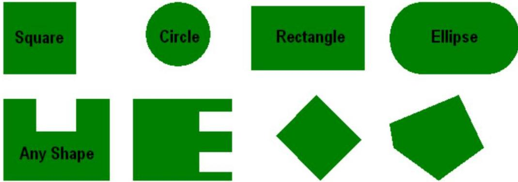
单个按键的尺寸，在满足面板的美学设计要求的情况下，必须通过合理安排的感应盘大小和间隔尺寸，来获得最佳的触摸感应效果，允许用户使用间距小到 1mm 的密集键盘。在一些特殊情况下，可以用牺牲按键感应盘间隙的尺寸来增大感应盘。
