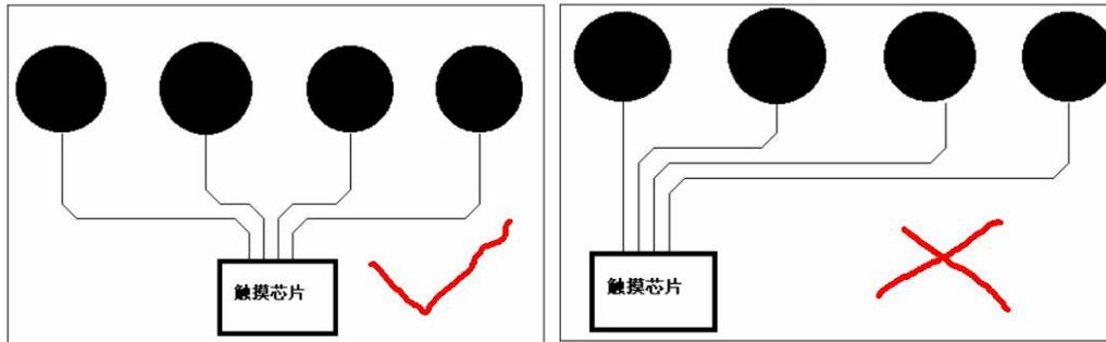
如果是两层板，触摸芯片和其它无源部件建议布局在底层，使其尽量靠近感应按键放置。
