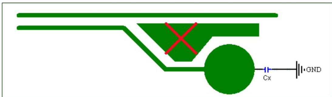
需要注意的是, 铺地比例增加虽在一定程度上增加了 PCB 的基准电容, 降低了触摸灵敏度, 但同时提高了抗干扰能力, 所以建议在保证灵敏度的情况下加大铺地的比例。
