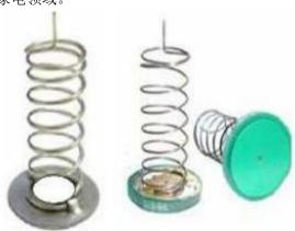
弹簧按键的 PCB 焊盘设计需要注意的是弹簧按键区域禁止铺地铜,背面可以根据具体情况选择铺网格铜,灵敏度比较充裕(外壳薄,介电常数大),可以铺,网格铜比例小于 30% (一般推荐)。灵敏度不充裕(外壳比较厚,介电常数小)就不铺,与正面一样禁止铺铜。
