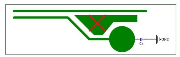
需要注意的是,铺地比例增加虽在一定程度上增加了 PCB 的基准电容,降低了触摸灵敏度 , 但同时提高了抗干扰能力,所以建议在保证灵敏度的情况下加大铺地的比例。
