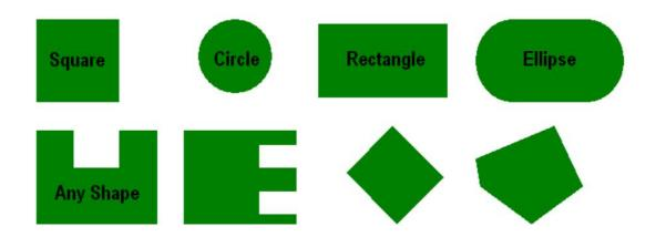
单个按键的尺寸,在满足面板的美学设计要求的情况下,必须通过合理安排的感应盘大小和间隔尺寸,来获得最佳的触摸感应效果,允许用户使用间距小到 1mm 的密集键盘。在一些特殊情况下,可以用牺牲按键感应盘间隙的尺寸来增大感应盘。
