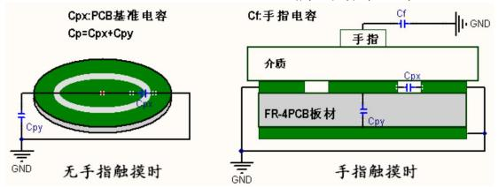
这个电容的变化引起芯片内部振荡频率或充放电时间的变化,使芯片内部能够检测到触摸发生,从而产生触发信号。电容的变化率越大,触摸就越易检测到。
