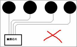
如果是两层板,触摸芯片和其它无源部件建议布局在底层,使其尽量靠近感应按键放置。 如设计滚轮时尽量把触摸感应芯片放在滚轮中心。
